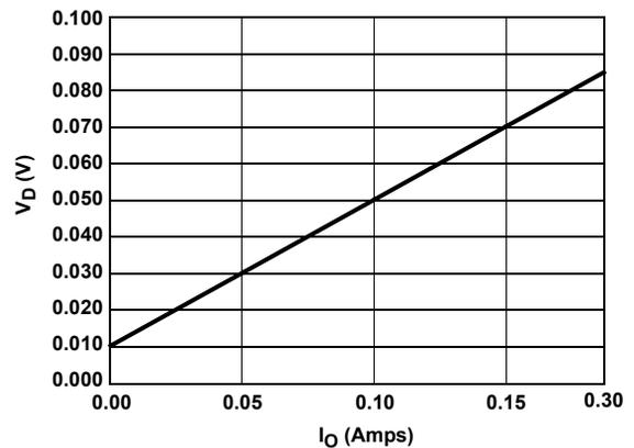
FIGURE 2. LD03 DROPOUT VOLTAGE
