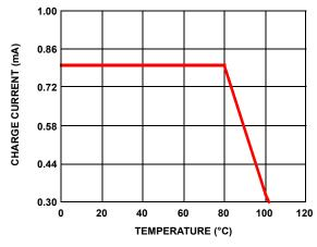
FIGURE 7. CHARGE CURRENT vs AMBIENT TEMPERATURE
