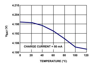
FIGURE 4. CHARGER OUTPUT VOLTAGE vs TEMPERATURE
