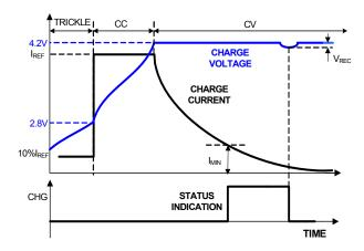
FIGURE 16. TYPICAL CHARGE CYCLE WITH TIMEOUT
