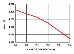
FIGURE 3. CHARGER OUTPUT VOLTAGE vs CHARGE CURRENT
