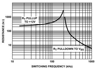
FIGURE 1. RT RESISTANCE vs FREQUENCY
