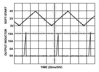
FIGURE 4. OVER-CURRENT OPERATION
