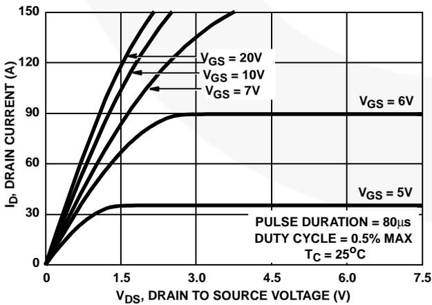
FIGURE 7. SATURATION CHARACTERISTICS
