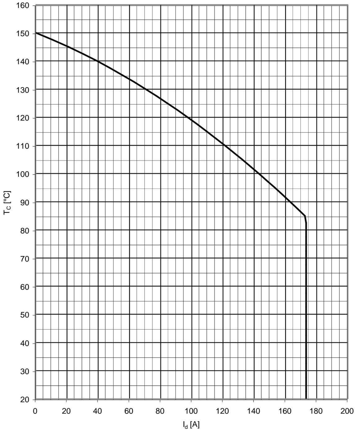
Höchstzulässige Gehäusetemperatur / Maximum allowable case temperatur  $T_c = f(I_d)$
